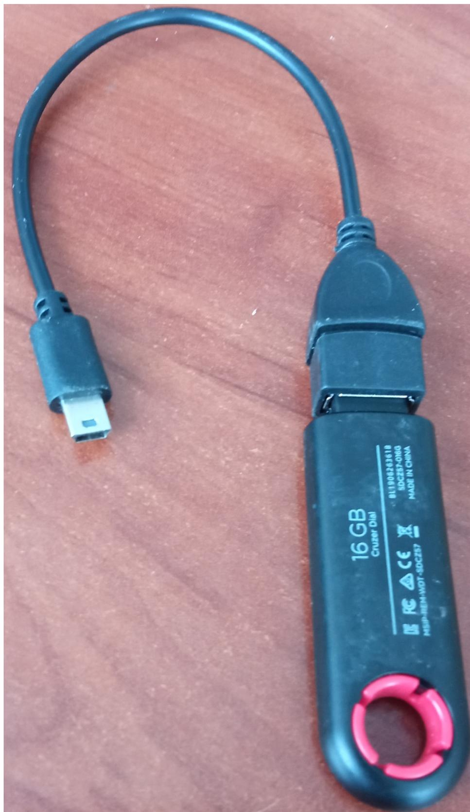
Подключить переходник к терминалу и включить терминал.
