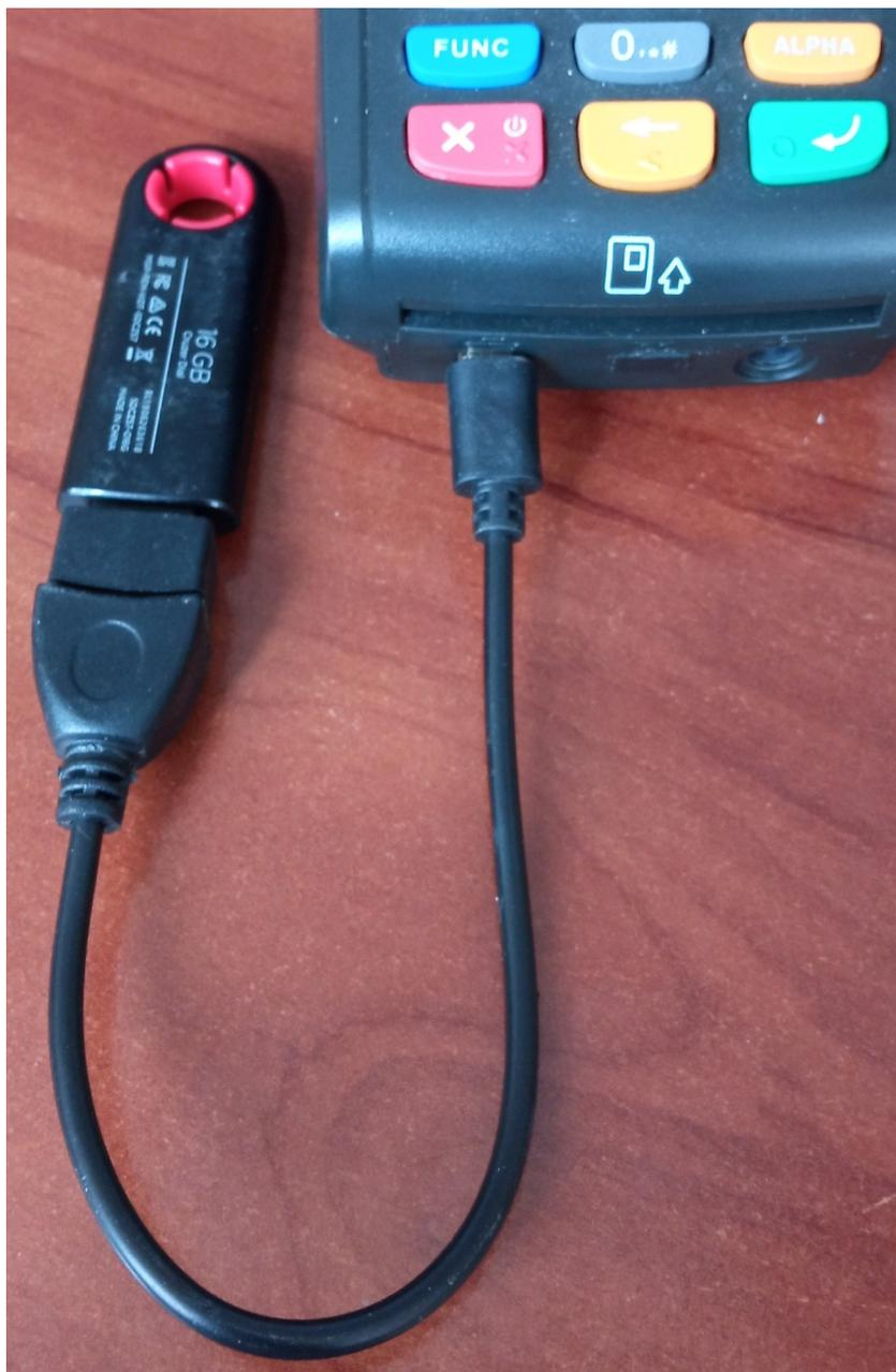
Включить терминал. Обнаружение флешки и запись на нее логов производится автоматически и не требует дополнительных настроек.
