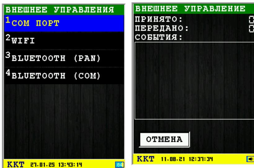
После открытия данного информационного диалога, запускаем на компьютере программу ККТWin. В полях ввода «Связи с ККТ» необходимо выбрать компорт и скорость передачи данных.
